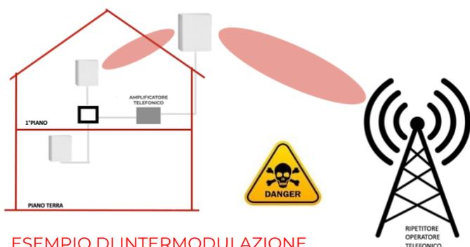
ESEMPIO DI INTERMODULAZIONE SENZA CONTROLLI
